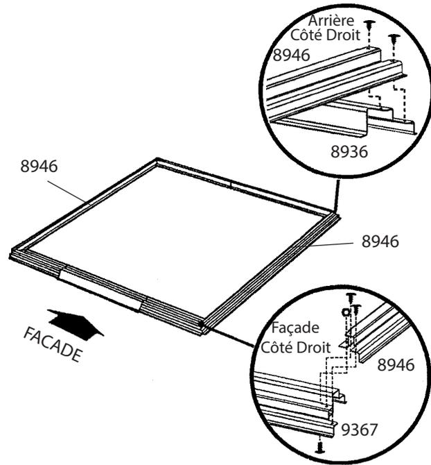
2 Mesurez les diagonales du cadre de plancher. Lorsqu'elles sont égales, le cadre de plancher est d'équerre.
