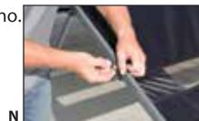
**Paso 2:** Desenganchar las varillas del toldo de la brazos tirando cuidadosamente de la varilla (Fig. O.).
